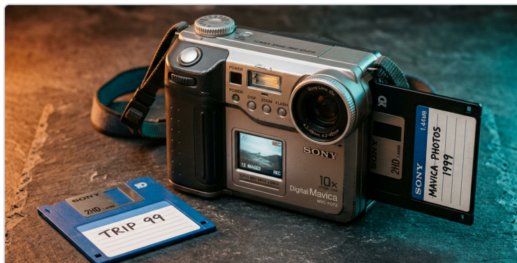
EL HARDWARE PIONERO (1999): La Sony Digital Mavica MVC-FD73 guardaba fotos en disquetes estándar de 3,5" (1,44 MB) a 640x480 píxeles. Con esta cámara se digitalizó paso a paso el conjunto histórico de Trujillo.
